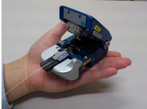
2. ファイバをセットしたファイバホルダをカッタに載せます。この時、ファイバホルダ先端をホルダステージに確実に当ててください。(下図参照)
