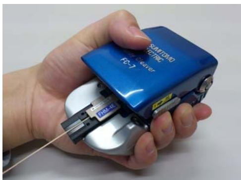
3. カバーを押すと切断刃が移動し、ファイバカットとファイバ屑の回収を行います。
