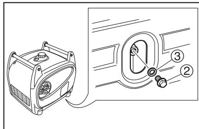
6. 新しいガスケット③とエンジンオイルドレンボルト②を取り付け、エンジンオイルドレンボルトを規定のトルクで締め付けます。
