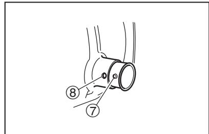
6. マフラー ワイヤネットとマフラー キャップを取り付け、マフラー キャップボルトを規定のトルクで締め付けます。
