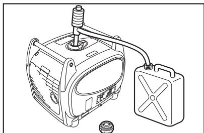
4. 燃料タンクキャップおよびストレーナを取り付けます。
