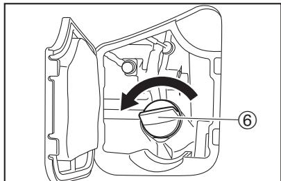
10. 新しいエンジンオイルを規定量（注入口の口元まで）給油します。
