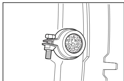
7. カバーを取り付けて、スクリュを締め付けます。
