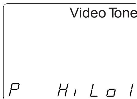
Abbildung 12. Videokabeltest mit ausgewähltem Pin
