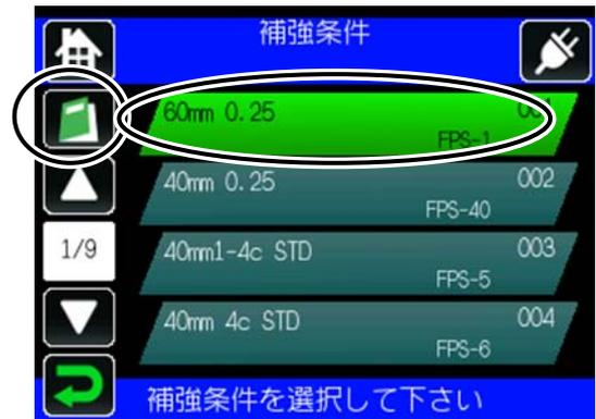
補強条件選択画面(4-2 ページ参照)で、設定変更したい補強条件を選択し、設定アイコン(
