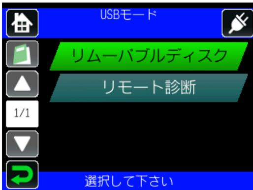
メニュー画面の USB アイコン(
