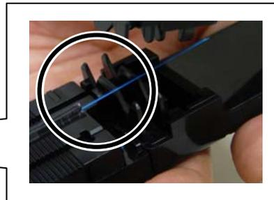
3. 被覆除去したケーブルをリムーバの溝部に合わせます。
