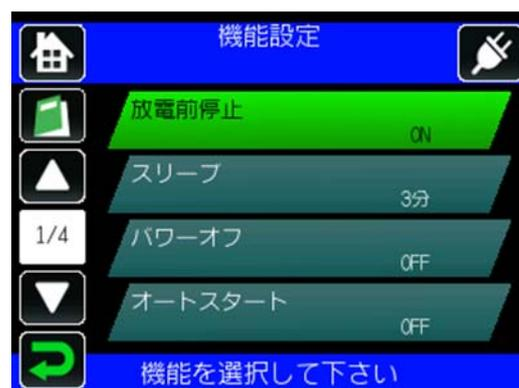
設定したい項目を押すと表示色が変わり、もう一度押すと設定変更画面に移動します。
