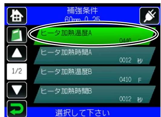
変更したい項目を押すと表示色が変わり、もう一度押すと設定変更画面に移動します。
