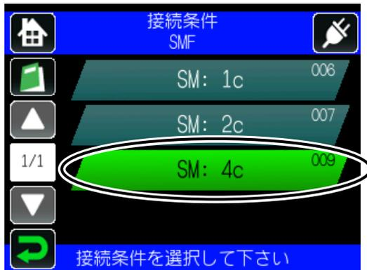
接続条件選択画面(4-1 ページ参照)で、設定変更したい接続条件を選択し、設定アイコン(
