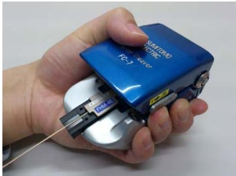
3. カバーを押すと切断刃が移動し、ファイバカットとファイバ屑の回収を同時に行います。
