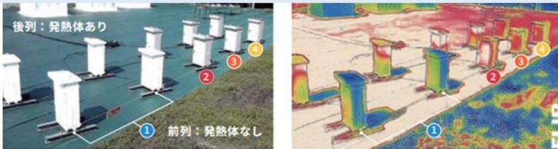
SPACECOOL を屋外機器の盤・キュービクルに直接貼り付けるだけで、内部温度を約  $-10^{\circ}\text{C}$  低下でき、内部機器の故障や劣化を抑制することができます。
