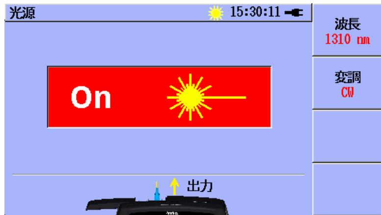
7. 光出力が停止するには、もう1度
