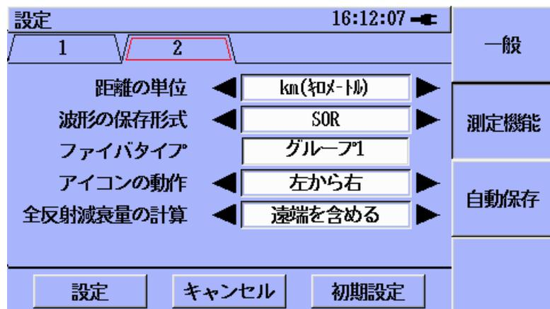
図3.3.2-3 測定機能設定画面 2 (Fiber Visualizer 機能の場合)
