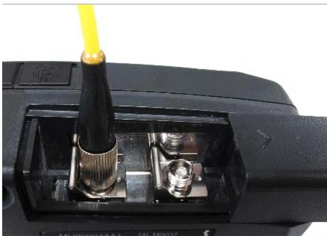
図2.6-1 光ファイバケーブルの接続
