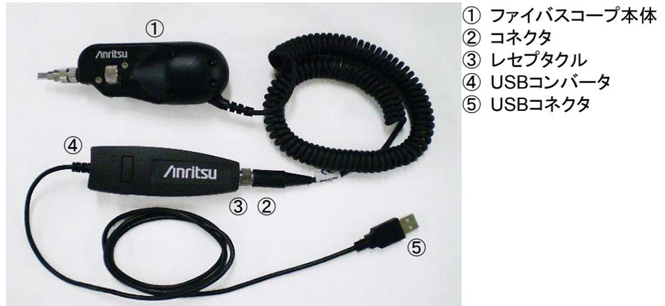
図9.2-3 USB コンバータへの接続
